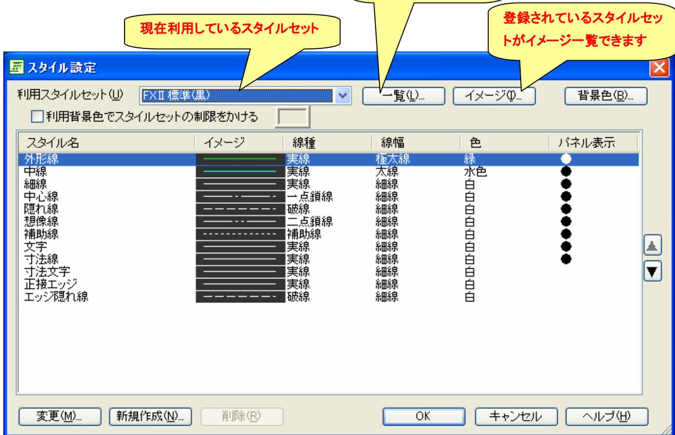
図面を開くと自動的に図面の属性に一番最適なスタイルセットを選択されます。また、スタイルセット一覧で
