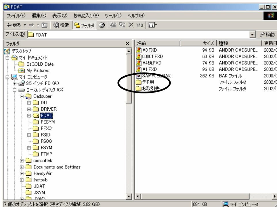
3. ドローイングシステムローカル設定-ファイルタブで、新しく作られたフォルダを指定してファイル場所を追加してください。
